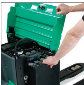
Versátil compartimento de la batería con tapa sin bisagras
